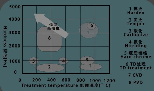
高精度的基材的表面处理应当选择较低温较高硬度的PVD涂层
