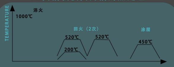
钢的热处理时首先加热到将近1000℃,一下子急冷使金属组织发生变化给予一定硬度。仅如此会韧性不足导致龟裂,所以有必要进行回火处理。回火有高温回火(520℃)与低温回火(200℃)会发生问题的就是低温回合的情况。我司涂层在450℃下进行,所以如果回火温度低于此温度会发生基材尺寸变形或者硬度降低等问题。所以如果考虑到涂层因素需要回火温度高于涂层温度并且最好能够进行2次回
